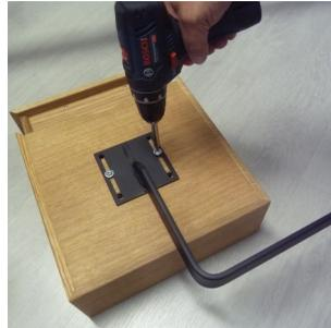
3. Konsole hinten am Bettkopfteil anschrauben (M6x16). 3 verschiedene Höheneinstellungen möglich.
