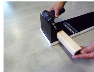
Seitenwange mit Kopfteil verschrauben. Schrauben (M6x20) immer leicht anziehen, dann festziehen.
